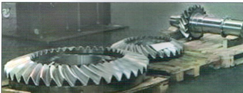
Рис. 6. Колеса и шестерни изготовленного редуктора
